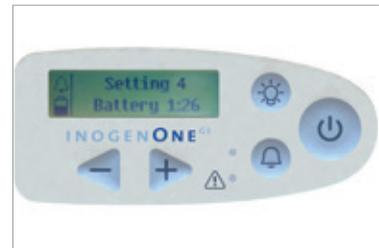
15. Die Lampentaste 10 Sekunden lang gedrückt halten. Auf dem Bildschirm wird die Meldung „sieve reset“ (Sieb zurücksetzen) angezeigt. Taste loslassen, wenn die Meldung angezeigt wird.
