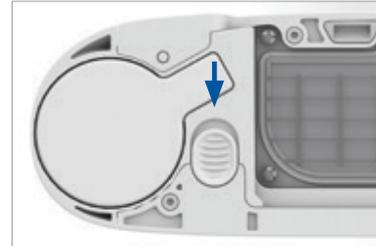
7. Während die Taste offen gehalten wird, die Säule (Metallröhre) herausschieben. Dazu die exponierte Aluminiumfläche mit einer Hand greifen.
