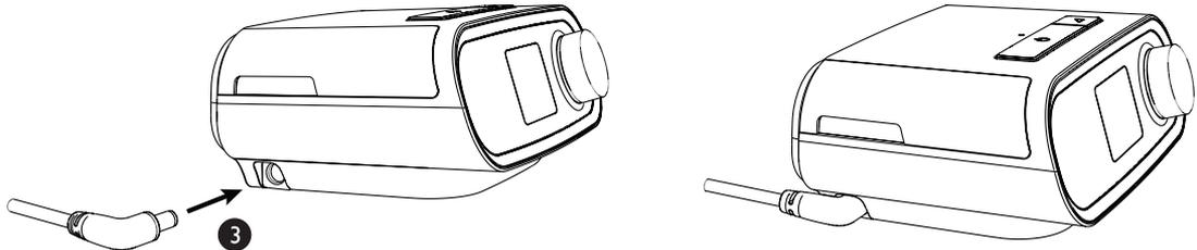
4. Prüfen Sie, dass die Stecker an der Geräteseite, an der Stromversorgung sowie an der Steckdose vollständig eingesteckt sind. Damit wird gewährleistet, dass der elektrische Anschluss sicher und zuverlässig ist.
