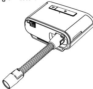
**Hinweis:** Wenn Sie anstelle eines beheizten Schlauchs einen Standardschlauch (nicht abgebildet) verwenden, müssen Sie den Schlauch einfach über die Luftauslass-Öffnung am Therapiegerät schieben.
