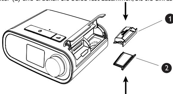
3. Setzen Sie die neue Filtereinheit an der Seite in das Therapiergerät ein. Klappen Sie die Abdeckung herunter, um sie zu verschließen.
