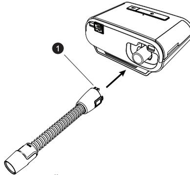
2. Drücken Sie den Schlauch über die Luftauslass-Öffnung, bis die Laschen an der Schlauchseite mit einem Klick in die Schlitz an den Seiten der Auslass-Öffnung einrasten.
