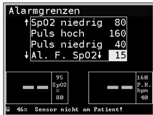
Abb. 50: Auswählen der Alarmfilterdauer
