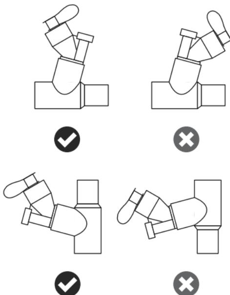
Figure 8. Utilisation optimale de l'Aerogen Solo
