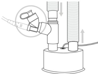
**Figure 7.** Aerogen Solo du côté sec de l'humidificateur
