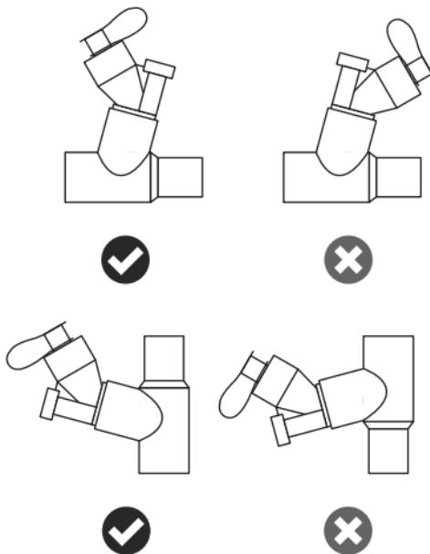
Afbeelding 8. Optimaal gebruik van de Aerogen Solo
