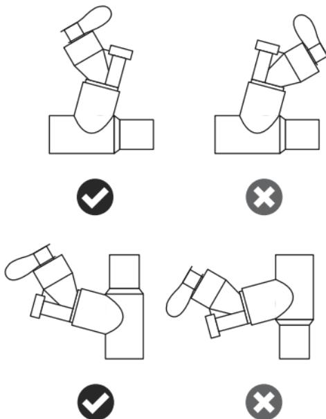
Rysunek 8. Optymalne działanie nebulizatora Aerogen Solo
