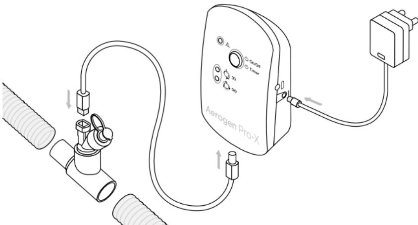
Rysunek 2. Montaż systemu Aerogen Solo
