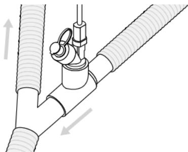
**Rysunek 5.** Podłączanie nebulizatora Aerogen Solo do obwodu oddechowego.
