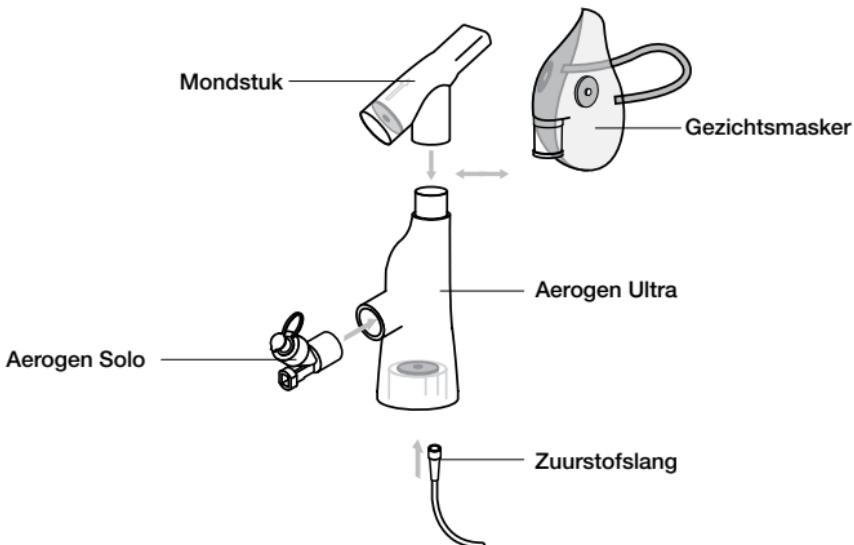
Afbeelding 11. Montage van de Aerogen Ultra
