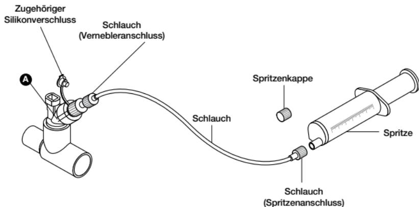
Abbildung 13. Schlauchset für die kontinuierliche Vernebelung
