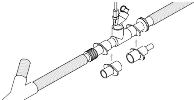
**Figure 6.** Raccordement à un circuit respiratoire pour nouveau-né
