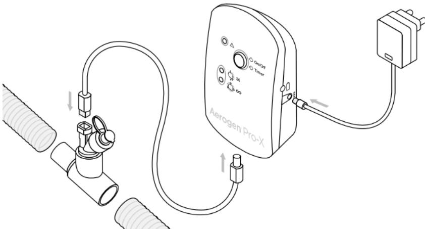
Afbeelding 2. Montage van het Aerogen Solo-systeem
