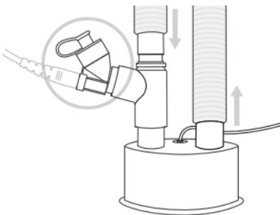
**Rysunek 7.** Nebulizator Aerogen Solo podłączony do ramienia wlotowego nawilżacza.
