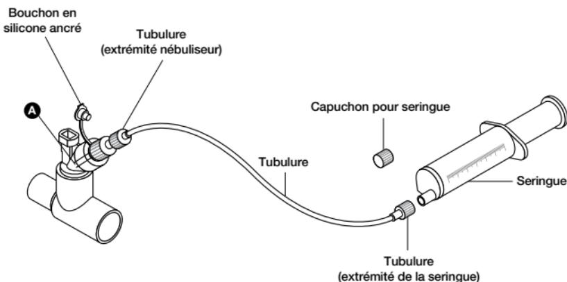
Figure 13. Kit de tubulure de nébulisation continue
