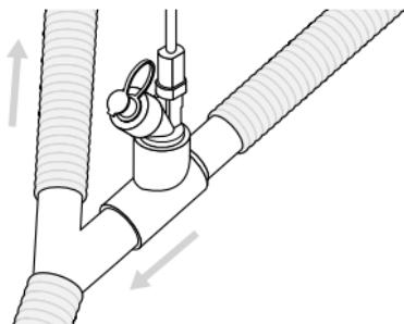
Figure 5. Connexion de l'Aerogen Solo à un circuit respiratoire
