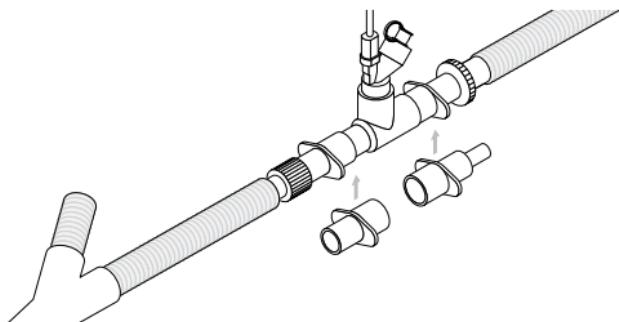
Afbeelding 6. Connecting to a neonate breathing circuit
