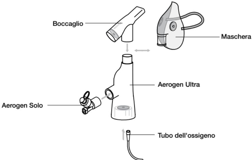
**Figura 11.** Montaggio dell'Aerogen Ultra
