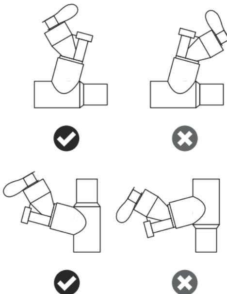
Abbildung 8. Optimaler Betrieb des Aerogen Solo
