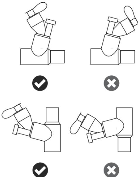
Figura 8. Uso ottimale del sistema Aerogen Solo
