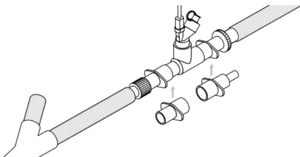
Figura 6. Collegamento a un circuito di respirazione neonatale
