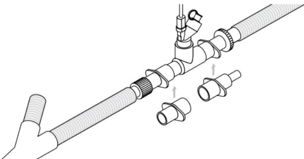
Abbildung 6. Anschluss an ein Beatmungsschlauchsystem für Neugeborene
