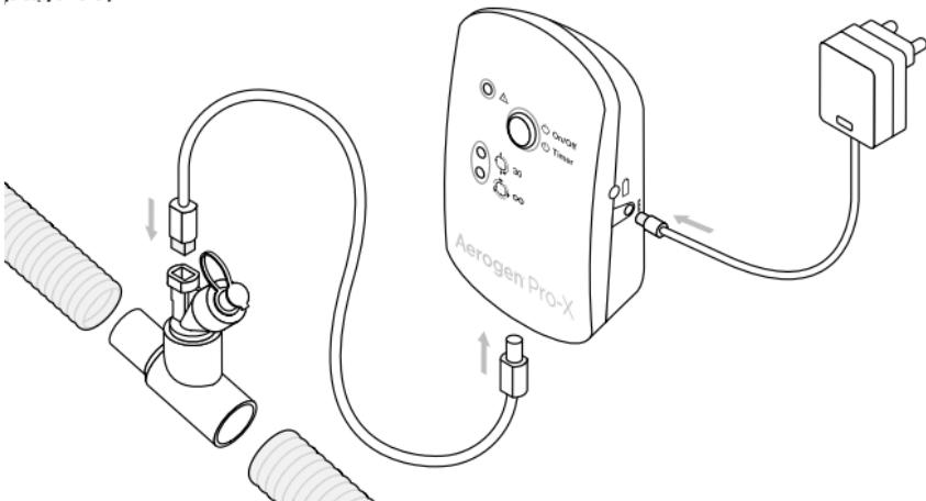
Figure 2. Assemblage du système Aerogen Solo
