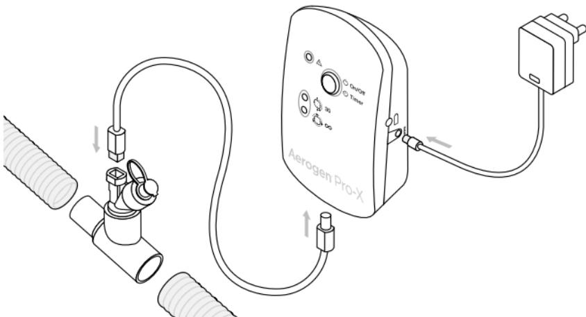
Abbildung 2. Zusammenbau des Aerogen-Solo-Systems
