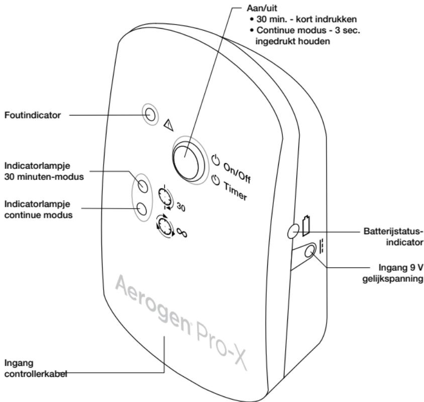
Afbeelding 4. Aerogen Pro-X Controls & Indicators
