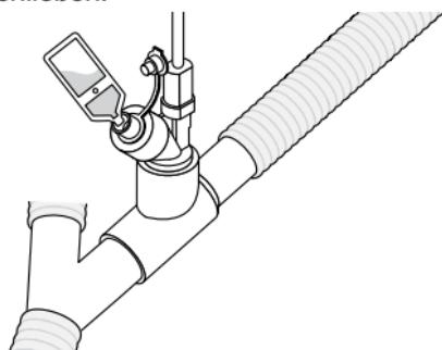
Abbildung 12. Füllen des Verneblers mit einer vorgefüllten Ampulle
