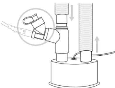
Figura 7. Aerogen Solo sul lato asciutto dell'umidificatore
