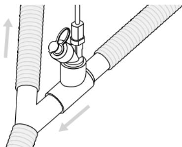
Figura 5. Collegamento dell'Aerogen Solo a un circuito di respirazione
