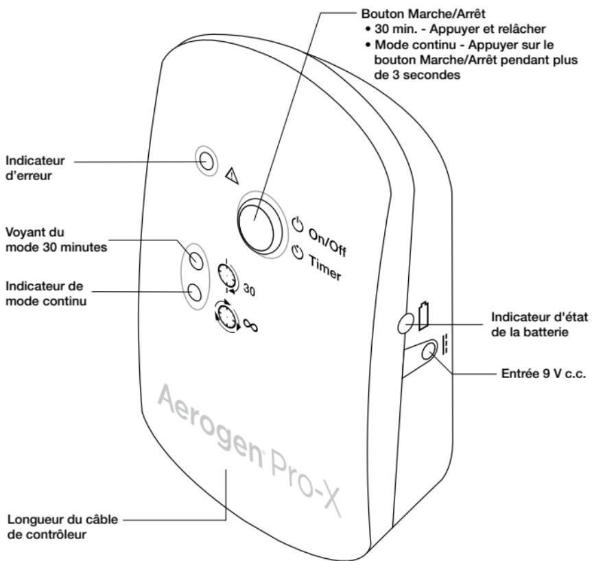
Figure 4. Contrôles et indicateurs de l'Aerogen Pro-X
