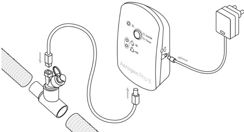
Figura 2. Montaggio del sistema Aerogen Solo
