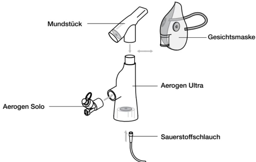
Abbildung 11. Aufbau des Aerogen Ultra
