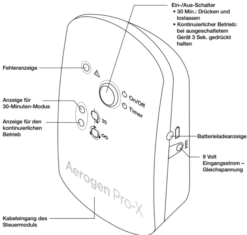
Abbildung 4. Aerogen-Pro-X-Bedienelemente und -Anzeigen
