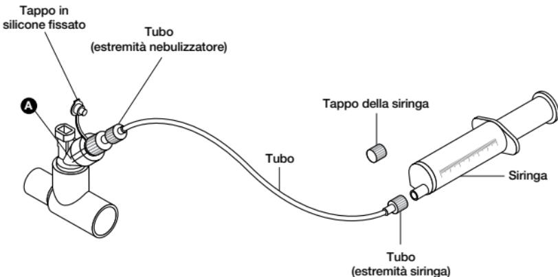
Figura 13. Set di tubi per nebulizzazione continua
