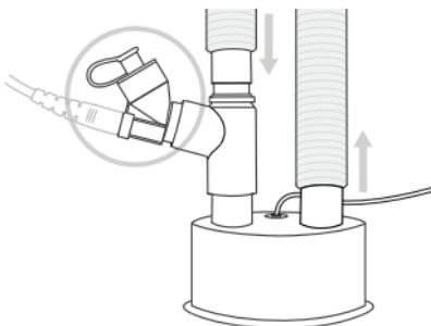
Abbildung 7. Aerogen Solo auf der trockenen Seite des Luftbefeuchters
