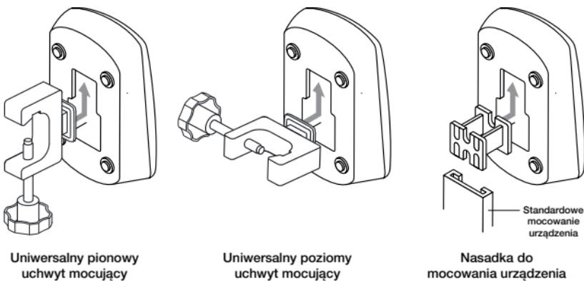
**Rysunek 3.** Sposoby montażu modułu sterującego Aerogen Pro-X i uniwersalnego uchwytu mocującego.
