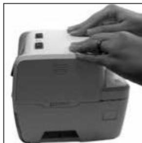
3. Füllen Sie die saubere Kammer mit destilliertem Wasser und führen Sie sie in die Basis ein. **HINWEIS** – Verwenden Sie destilliertes Wasser, um mineralische Ablagerungen im Inneren der Kammer zu vermeiden.
