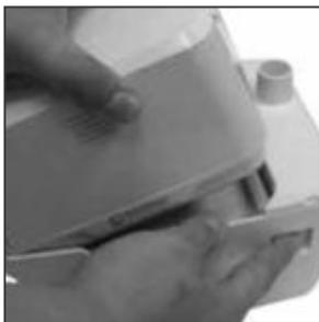
**HINWEIS** – Zum Trennen muss die Entriegelungstaste des Flowgenerators vollständig gedrückt werden.
