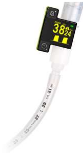
Abbildung 7. EMMA-Kapnograph verbunden mit Endotrachealtubus.
