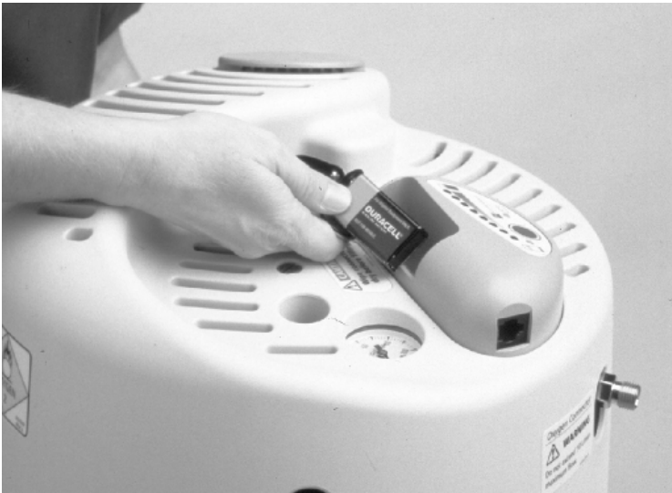
Figura 13. Sostituzione della batteria
