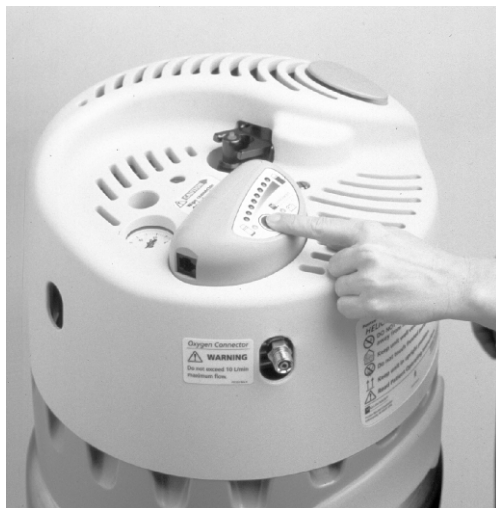
Afbeelding 11: Het controleren van de zuurstofinhoud van het reservoir
