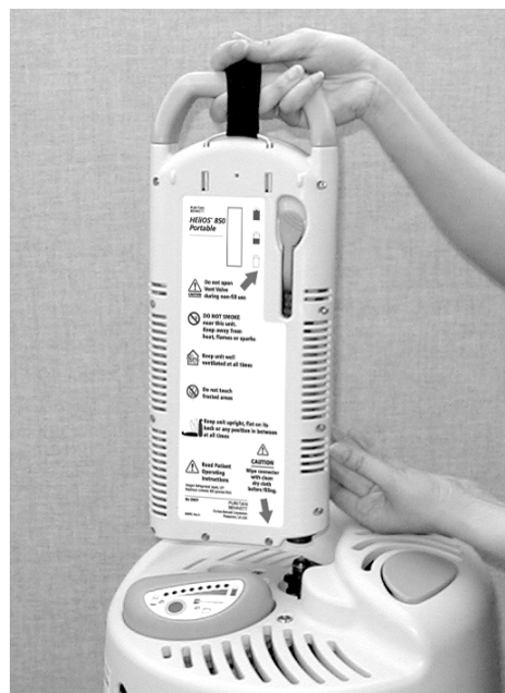
Figura 1. Posizionamento dell'elemento portatile H850 per il riempimento
