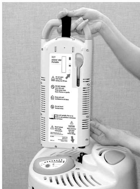
Figure 1: Placement de l'unité H850 Portable pour le remplissage
