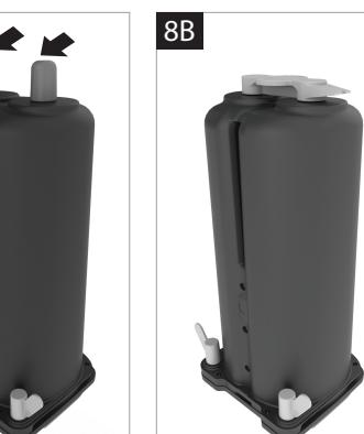
9. A/B. Säuleneinheit in den Inogen One® G5 Konzentrator einführen. Die Säulenenden nicht exponiert lassen. Diese sind in den Inogen One G5 einzusetzen, sobald die Staubkappen entfernt wurden.
