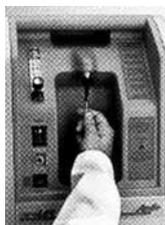
Schieben Sie den Schlauchanschluss auf den Anschlussstutzen (O<sub>2</sub>-Ausgang) an der Gerätevorderseite.
