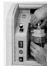
1. Schrauben Sie das Oberteil des Kunststoffbechers an den Metallanschluss des Konzentrators. Drehen Sie den durchsichtigen Kunststoffbecher vom Oberteil ab und füllen Sie diesen bis zur Markierung „maximal“ mit Wasser (mit Aqua dest. oder mit abgekochtem und anschließend abgekühltem Leitungswasser). Danach schrauben Sie den Kunststoffbecher wieder an das Oberteil.
