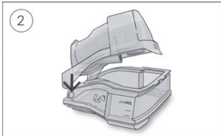
1. Führen Sie eine Seite des Deckels in die Scharnieröffnung am Unterteil ein.
