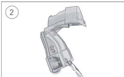
1. Greifen Sie den Befeuchter von oben und unten, drücken Sie ihn leicht zusammen und ziehen Sie ihn aus dem Gerät.
