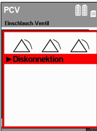
Wird durch einen Fehler ein Alarm ausgelöst (hier: Diskonnektionsalarm), können Sie durch Drücken der Alarm-Quittierungstaste
