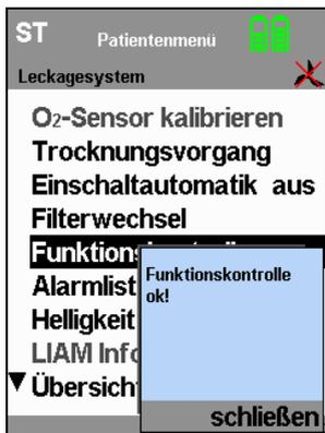
6. Bei erfolgreich abgeschlossener Funktionskontrolle erscheint die Meldung **Funktionskontrolle ok!**
