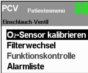
1. Stellen Sie sicher, dass der Sauerstoffsensor angeschlossen ist.
