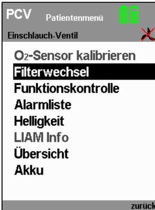
1. Um die Filterwechselanzeige zurückzusetzen, drücken Sie die Menütaste
