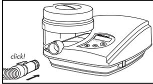
4. Stecken Sie den Adapter des Atemschlauches in den Geräteausgang des Therapiegerätes. Achten Sie darauf, dass die Verriegelungstaste dabei nach oben zeigt und in der Nut des Geräteausganges einrastet.
