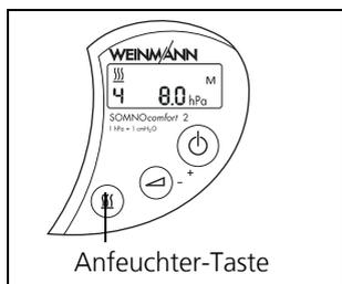
3. Drücken Sie die Anfeuchter-Taste Ihres Therapiegerätes. Das Anfeuchter-Symbol , sowie die Befeuchtungsstufenanzeige (hier Stufe 4) werden im Display des Therapiegerätes angezeigt.
