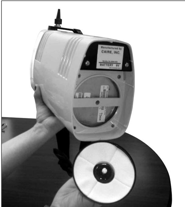
6. Entfernen Sie die Feuchtigkeit von der Kondensationschale, nachdem Hi Flow leer ist und Raumtemperatur angenommen hat.
