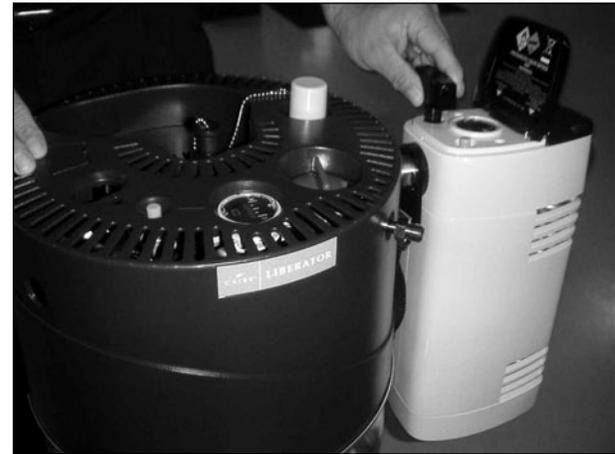
9. Nachdem Sie Hi Flow befüllt haben und das Entlüftungsventil geschlossen haben, drehen Sie die tragbare Einheit solange gegen den Uhrzeigersinn, bis die Einheiten getrennt sind.
