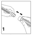
Trennen Sie den Atemschlauch vom Verbindungsschlauch ab.
