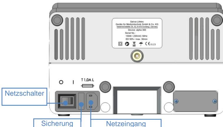
Das Originalnetz Kabel wird mit dem Netzeingang auf der Rückseite des Gerätes verbunden.
