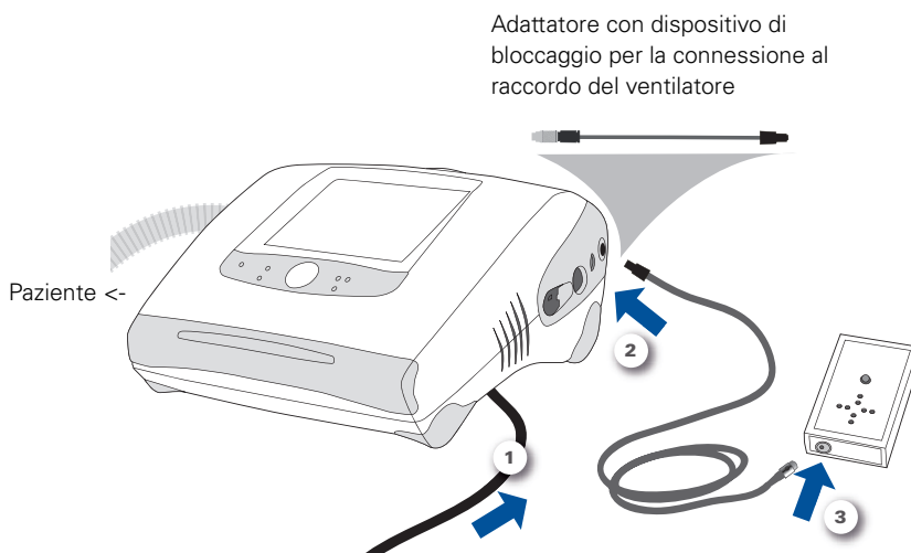
Figura 5: Connessione della scatola dell'allarme a un ventilatore Elisée, dettaglio della presa
