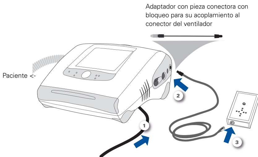
Figura 5: Conexión al ventilador Elisée y detalle de la base de conexión del conector
