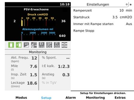
**1** Wählen Sie mit den Pfeiltasten die Einstellung **Rampe stopp** und stoppen Sie die Rampe durch Drücken der Rechtspfeil-Taste.
