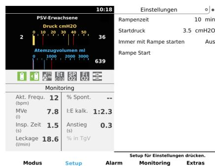
1 Wählen Sie mit den Pfeiltasten die Einstellung **Rampe start** und starten Sie die Rampe durch Drücken der Rechtspfeil-Taste.
