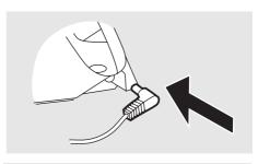
2 Schließen Sie das Netzanschlusskabel an das Netzteil an.
